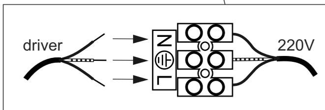
**ВАЖНО:** Установка светильника должна производиться при обесточенной электросети.
